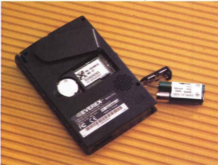
Le due batterie ricaricabili in dotazione, la batteria tampone e l'espansione di memoria. L'Everex non può ricaricare le normali batterie ricaricabili perché il polo negativo del caricabatterie è sul lato di una delle due.
